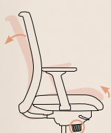
Synchrone : réglage manuel de la tension du dossier via une molette située sous le mécanisme
